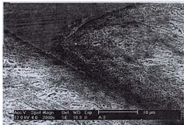
Gambar 12. Void pada adiabatic shear band teramati di sampel A.2
